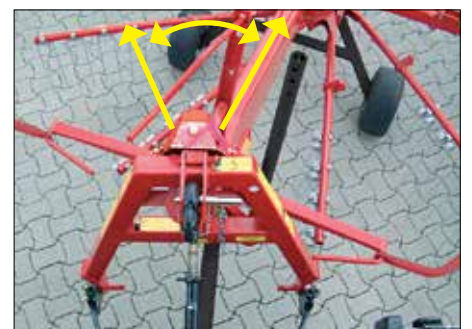
Der 3-Punkt-Gelenkbock mit Gelenkverbindung ist so entwickelt, dass der Schwader dem Traktor sicher bei allen Kurvenfahrten folgt.
