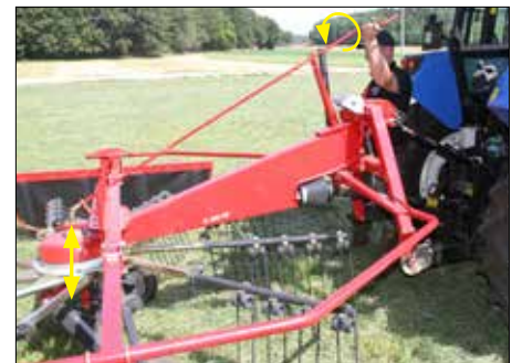
Die Arbeitshöhe lässt sich einfach mittels des praktischen Handgriffes über der Aufhängung einstellen.
