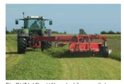
Die GMT L / Flex Mähwerke können mit dem Collector für Schwadzusammenlegung ausgestattet werden. So können Doppelschwaden für die nachfolgende Maschine abgelegt werden - zur Optimierung der Maschinenkette.
