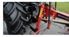
3-Punkt-Gelenkbock mit Gelenkverbindung.
