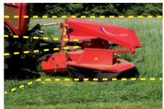
Contour Float - Senkrechte Bewegung (55 cm). Contour Float - ständig parallel zum Boden.
