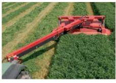
Die Flex-Maschinen sind mit einer langen, kräftigen, mittelmontierten Zugdeichsel ausgerüstet.
