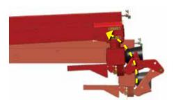
Bei einem sehr großen Hindernis öffnet sich zusätzlich die Zugbalkenverlängerung, und die Maschine hebt sich noch höher aus - teure Reparaturen werden so sicher vermieden.
