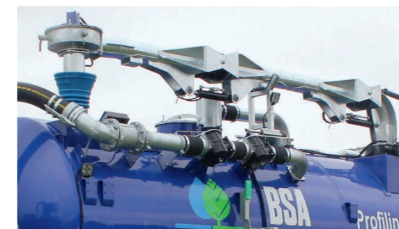
Druckleitung mit Durchflussmessung außenliegend Einspeisung obenliegend.
